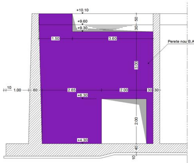
Figura 3. Lucrări bazine biologice
