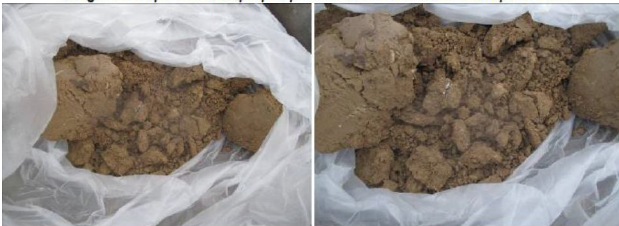
Imagini cu probele de sol prelevate de la adancimea 0,40 - 1,80 m din forajele geotehnice
