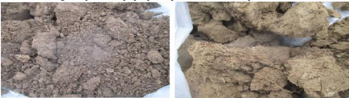
Imagini cu probele prelevate de la adancimea 1,00 si 1,50 m din forajele geotehnice
